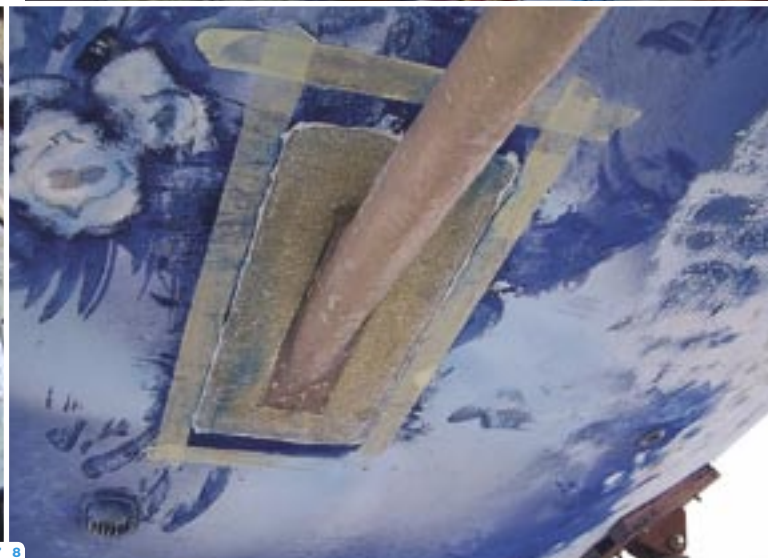
5: Ustrezno obrušeno oz. pripravljeno- mesto vgradnje pred plastifikacijo statvene cevi. 6: Statvena cev s centrirnimi obroči, ki jih je potrebno po končani montaži nujno odstraniti. Gred mora biti v delovnem položaju. 7: Mesto med statveno cevjo in trupom plovila zapolnimo s kitom oziroma smolo. 8: Kit naneseemo tudi s spodnje strani plovila, zapolnimo vsa prazna mesta in počakamo da se kit strdi.
