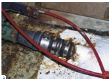
2: Zarezni vpliv neustrezne objemke lahko povzroči pretrganje gumijaste manšete. 3: Razpoložljivi prostor pogojuje izbiro tesnilnega sistema. 4: Korozijsko poškodovani deli potrebni zamenjave.
