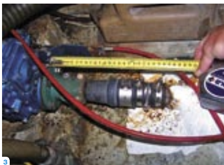
2: Zarezni vpliv neustrezne objemke lahko povzroči pretrganje gumijaste manšete. 3: Razpoložljivi prostor pogojuje izbiro tesnilnega sistema. 4: Korozijsko poškodovani deli potrebni zamenjave.
