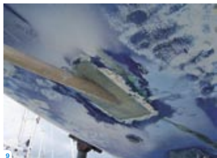
9: Po potrebi dodamo še sloje steklene tkanine in s smolo zgladimo površino. 10: Štrleči zunanji del statvene cevi obrežemo ob trupu plovila.
