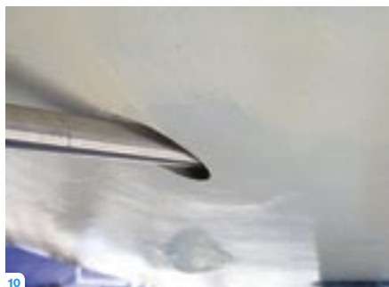
9: Po potrebi dodamo še sloje steklene tkanine in s smolo zgladimo površino. 10: Štrleči zunanji del statvene cevi obrežemo ob trupu plovila.
