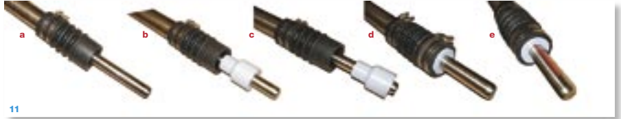
11: a) na statveno cev namestimo manšeto, b) natakemo tesnilni sistem, c) z nežnim nasprotnim potegom odvihamo morda zavihane pahljače, d) tesnilni sistem potisnemo v manšeto in privijemo objemke, e) odstranimo ujeti zrak
