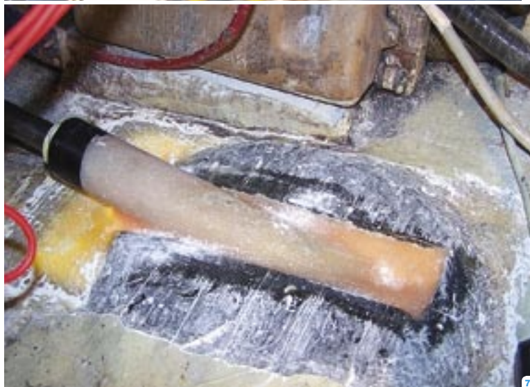
5: Ustrezno obrušeno oz. pripravljeno- mesto vgradnje pred plastifikacijo statvene cevi. 6: Statvena cev s centrirnimi obroči, ki jih je potrebno po končani montaži nujno odstraniti. Gred mora biti v delovnem položaju. 7: Mesto med statveno cevjo in trupom plovila zapolnimo s kitom oziroma smolo. 8: Kit naneseemo tudi s spodnje strani plovila, zapolnimo vsa prazna mesta in počakamo da se kit strdi.
