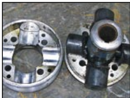
10: Poškodovani gumijasti elementi v spojki povzročajo tresljaje na celotnem pogonskem sklopu.
