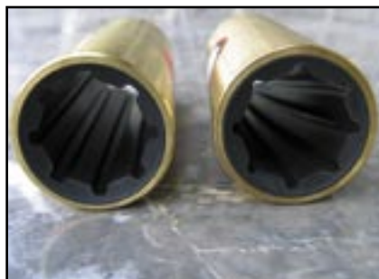
8: Manjša obraba in boljše vodenje gredi ob uporabi zavitih gumijastih ležajev.
