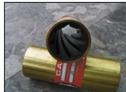
9: Izbira zavitega ležaja z desno ali levo vijučnico je pogojena s smerjo vrtenja pogonske gredi.
