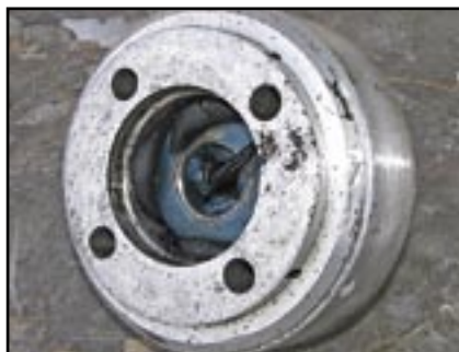
11: Gumijasta elastična spojka kmalu povzroča več problemov kot koristi.
