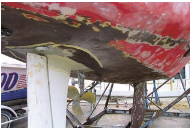
6: Ustrezno sanirano krmilo in stabilizator krmila; plovilo je pripravljeno za barvanje.
