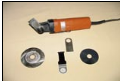
3: Ročni rezalni stroj z priključki-noži, ki s hitrimi nihaji noža odstranjuje material brez prašenja
