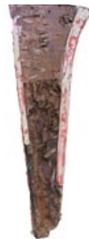
2: Segnit les v notranjosti stabilizatorja krmila
