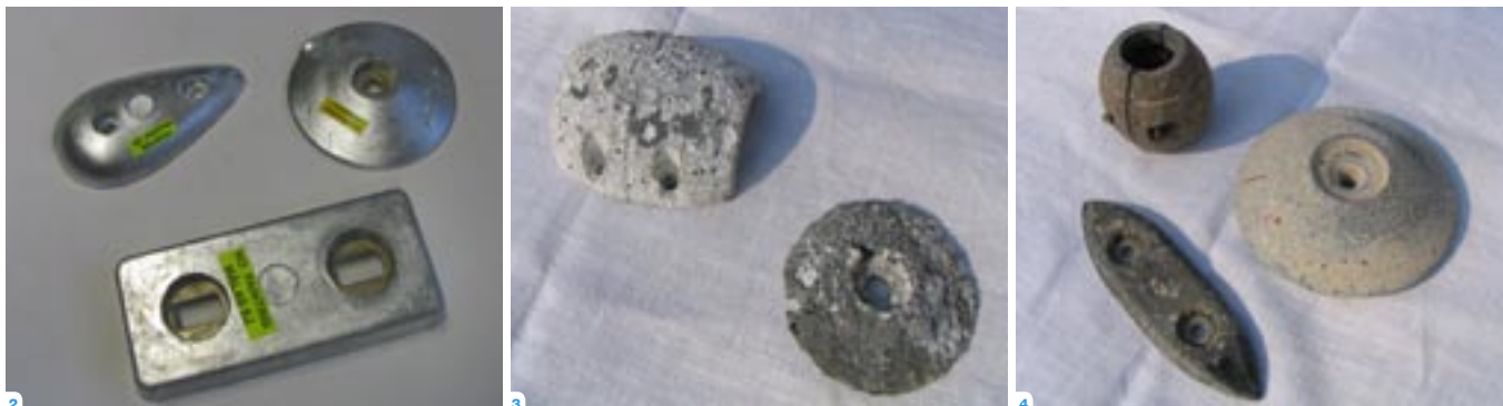
2: Različne oblike anod priznanih izdelovalcev, primerne za različna montažna mesta. 3: Pravilno iztrošene anode, katere je potrebno takoj zamenjati z novimi. 4: Nekakovostne in hkrati nedelujoče anode, ki zaradi neprimerne sestave materiala ne ščitijo plovila pred korozijskimi procesi.
