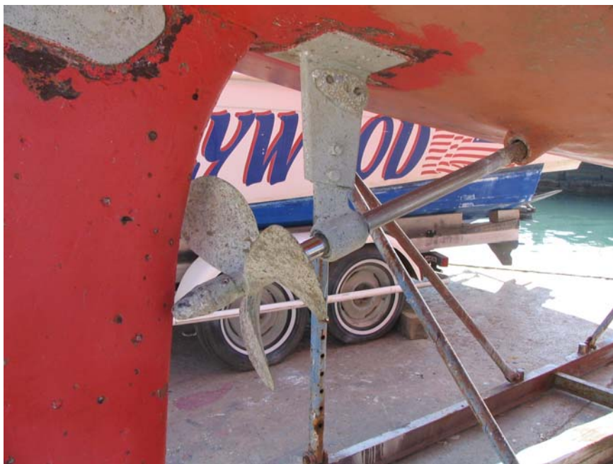
Slika 1: Poškodbe na stabilizatorju krmila - vdor vode in poškodbe na mestu vpetja nosilca vijaka
