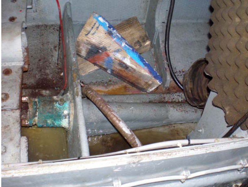
Slika 3: Star sistem tesnjenja z vrvico, v celoti oplastificirana statvena cev
