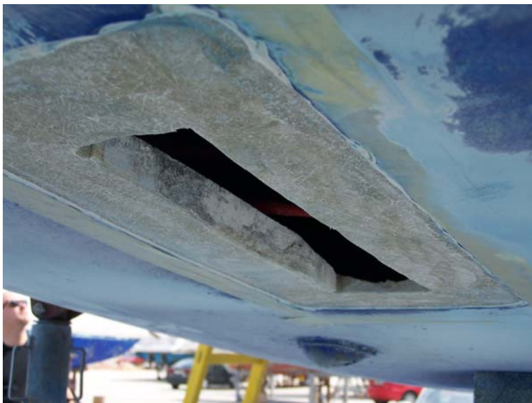
Slika 4: Priprava montažnega mesta – odstraniti vrhnji premaz in gelcoat, tako da so nitke steklene tkanine (mate) jasno vidne
