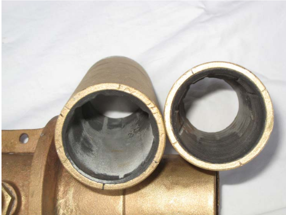
Slika 8: Obrabljeni gumijasti ležaj v nosilcu vijaka – nujno potreben menjave - možnost vibracij, slabo naleganje in hlajenje, povečano trenje
