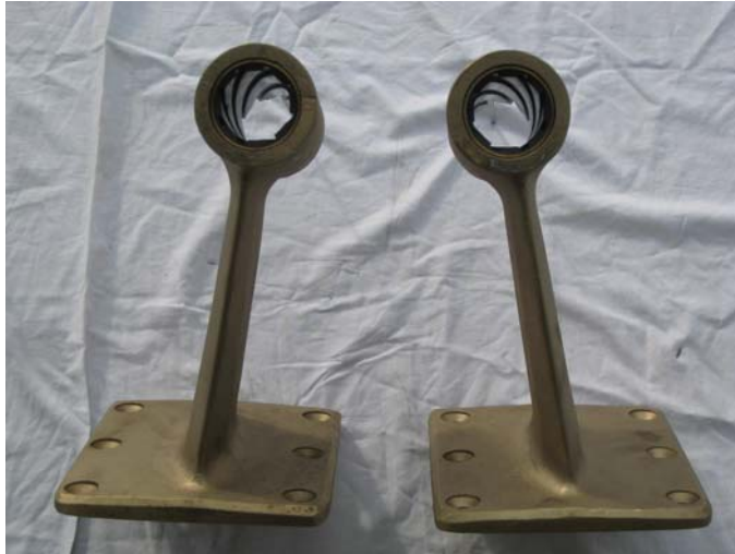
Slika 6: Nosilec vijaka oziroma pogonske gredi za motorni čoln z gumijastim ležajem (vijačenje na trup plovila)
