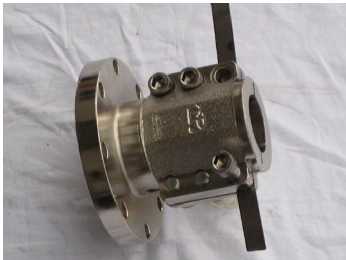
Slika 3: Vstavimo jekleno ploščico, za potrebe demontaže
